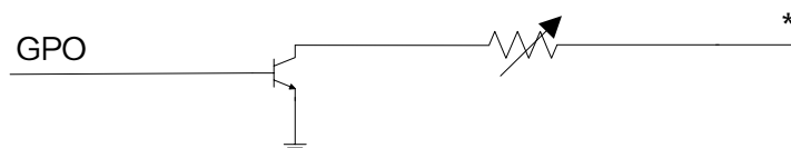
图6-7 非隔离输出内部电路
