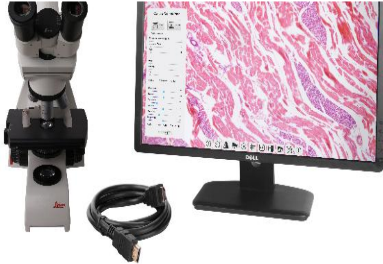
图 7-1XCAMLITE4K 系列相机通过 HDMI 线连接到 HDMI 接口显示器
